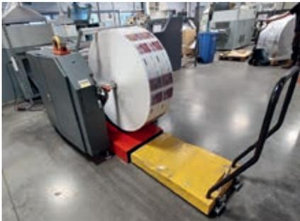
Dans le cadre de l'amélioration de l'ergonomie des postes de travail des rampes de descente de bobine adaptées aux enrouleurs ont été fabriquées sur mesure sur le site de **Noyelles**.
